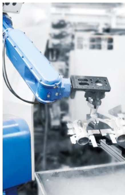
平行夹爪 (MCHJ), 压铸件夹取应用
