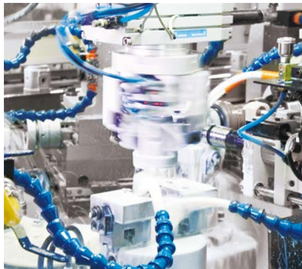
旋转缸 (MCRQ2) 与平行夹爪 (MCHX2) 搭配, 自动加工机应用
