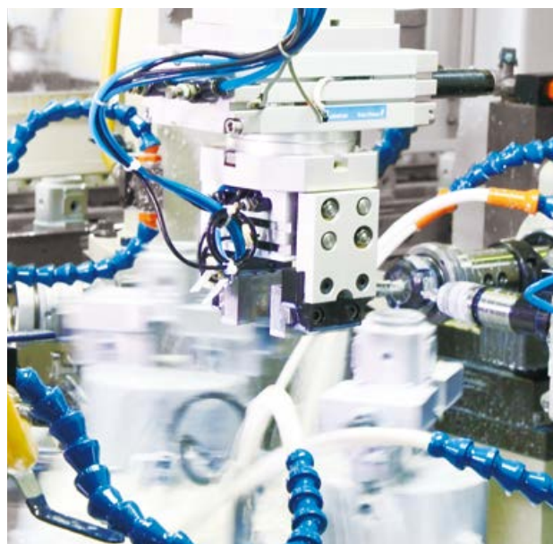
旋轉缸 (MCRQ2) 與平行夾爪 (MCHX2) 搭配，自動加工機應用。
