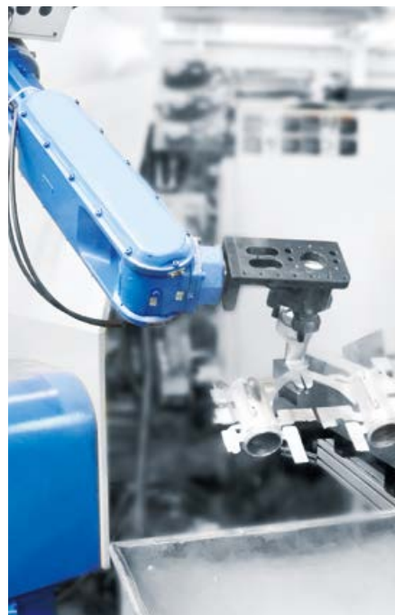
平行夾爪 (MCHJ)，壓鑄件夾取應用。
