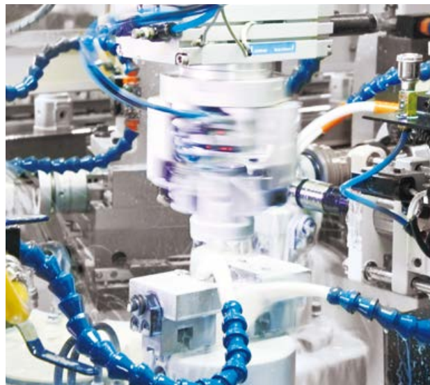
旋轉缸 (MCRQ2) 與平行夾爪 (MCHX2) 搭配，自動加工機應用。
