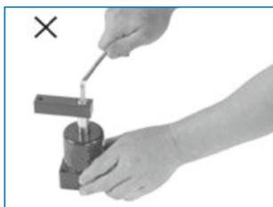
壓板拆卸操作方式
