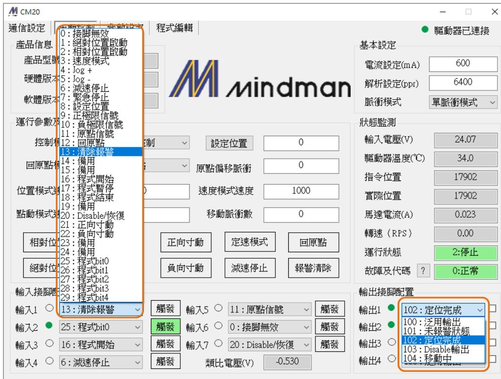
在參數設定頁面中也可以設定「05：輸入接腳配置」及「06：輸出接腳配置」的定義。
