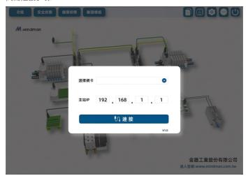
點擊主視窗(進入軟體初始介面)「顯示連接閥島介面」,選擇對應的網卡與填寫正確的閥島 IP 後點擊「連接」,軟體提示連接成功後自動跳轉至功能介面。
